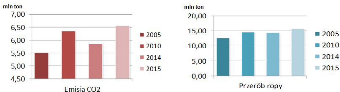
Rys. 2. Emisja dwutlenku węgla w kompleksie rafineryjno-petrochemicznym wraz z przerobem ropy naftowej w wybranych latach
